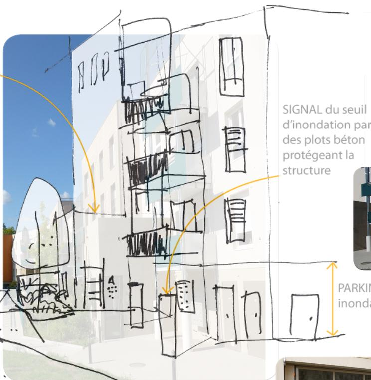
SIGNAL du seuil d'inondation par des plots béton protégeant la structure
